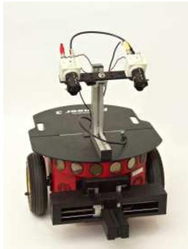
Abbildung 1.1: Stereo-Vision-System bei einem Roboter
