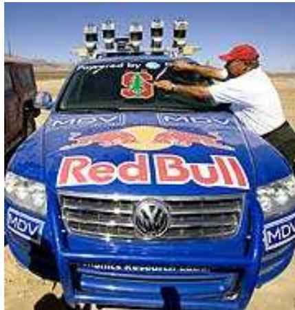
Abbildung 1.3: Volkswagen Touareg namens Stanley von der Stanford University gewann das DARPA Grand Challenge im Jahr 2005. Die Aufgabe bestand darin, selbständig durch eine Wüste den Weg zum Ziel zu finden. Stanley hatte mehrere Kameras am Bord, um eine Rundumsicht sowie Tiefenwahrnehmung zu ermöglichen
