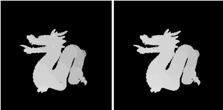
Abbildung 5.6: Rekonstruktion mittels unseren Algorithmus. *Links*: Rekonstruktion mit nur 16 Labels. *Rechts*: Rekonstruktion mit 32 möglichen Tiefenwerten.
